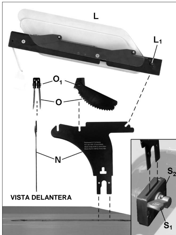
Figura 6-10: instalación del conjunto de protector
