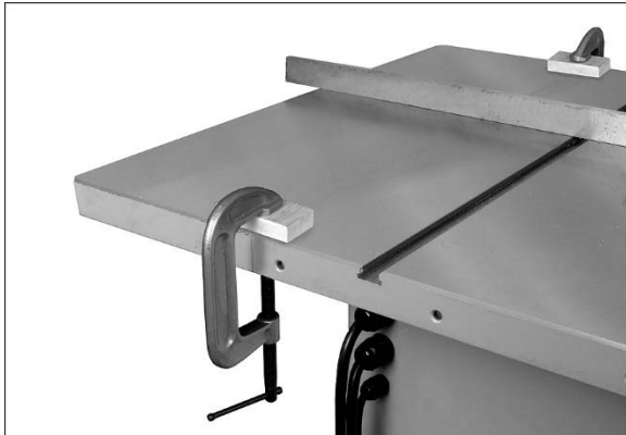
Figura 6-5: nivelación de las alas de extensión, método 2
