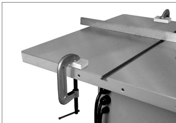
Figure 6-5 : mettre à niveau les rallonges, méthode 2
