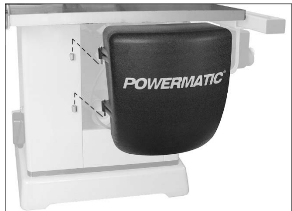
Figura 6-7: instalación de la cubierta del motor
